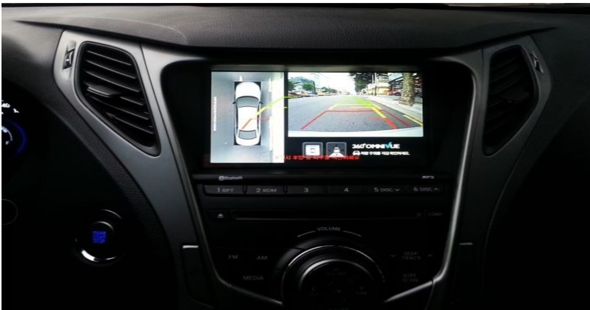
Bild: Top-view Kamera-System mit einem Original Gerät. Ansicht der Heckkamera
